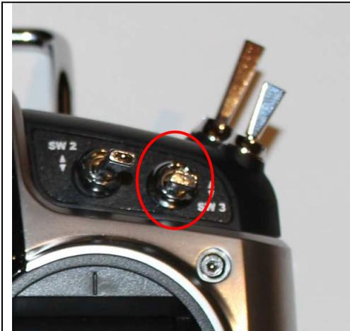
Der Schalter „SW3“ aktiviert die Höhenregelung. Steht der Schalter nach hinten (wie auf dem Bild) ist die Höhenregelung inaktiv. Steht der Schalter nach vorne. Ist die Regelung aktiv
