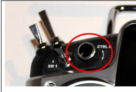
Mit diesem Drehregler (CTRL6) werden die Motoren regulär ein- und ausgeschaltet. Zum Einschalten der Motoren drehen Sie den Drehregler ganz nach rechts. Im Gegensatz zum Notstopp- Schalter verhindert der Drehregler wirkungsvoll, dass der Kopter versehentlich eingeschaltet wird.
