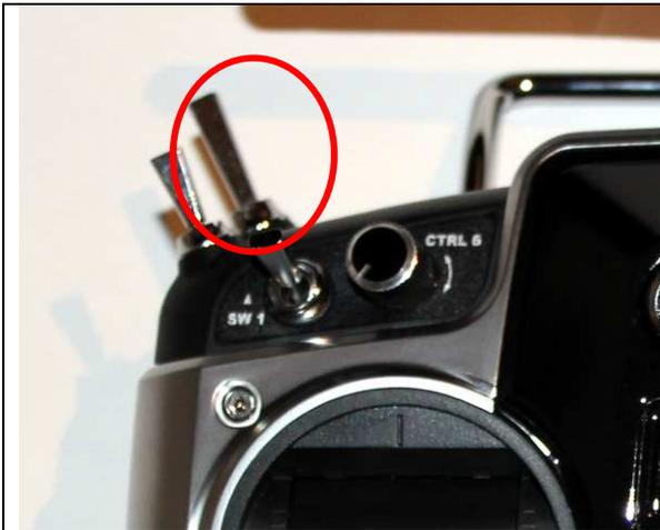
Mit diesem Schalter (SW8) kann der Kopter jederzeit sofort ausgeschaltet werden. (Schalter nach oben ziehen). Dies ist immer dann notwendig, wenn der Kopter in eine Notsituation kommt, beispielsweise, wenn er auf Personen zufliegt.
