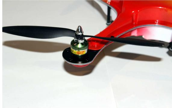
Durch die tiefgezogenen Verkleidungen ist die Elektronik optimal geschützt und somit sind Flüge auch bei Regen und Schneefall möglich.
